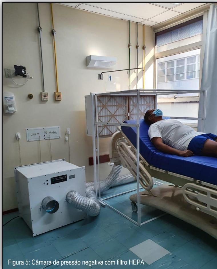
Figura 5: Câmara de pressão negativa com filtro HEPA
