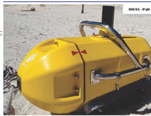
Figura 1 - Invólucro de testes do SINVSA.
