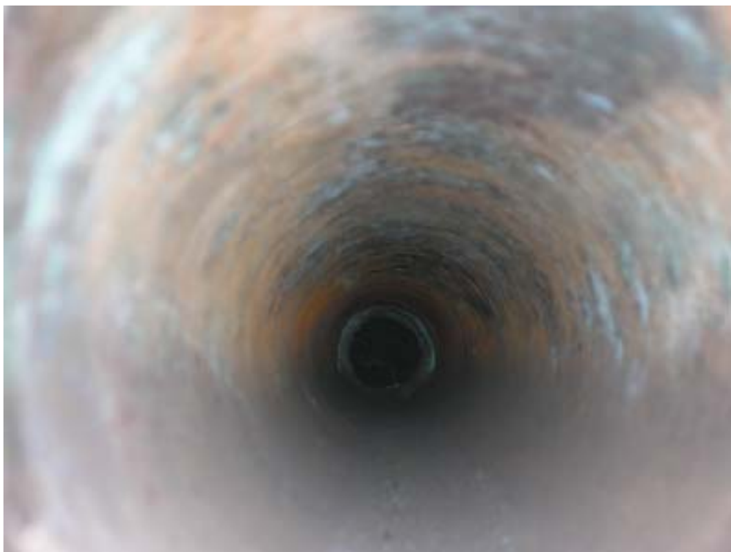
FIGURA 10 - Tubo alma da meia-colubrina 2500-2-18, mostrando a redução de diâmetro FONTE: Foto DPHCM.
