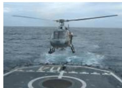
Para a qualificação, foram realizadas 8 horas de voo de helicópteros Esquilo (UH-13), 32 pousos e 21 manobras de Pick-Up/Vertrep, que envolvem a retirada de carga, o transporte por helicóptero e o posterior recebimento por um navio.
