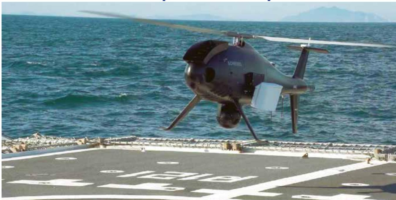
*Aeronave remotamente pilotada embarcada Camcopter-S100 operando a partir do convés do NPaOc "APA"*
