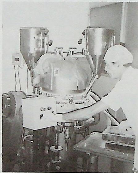
Operação da máquina compressora de comprimidos
