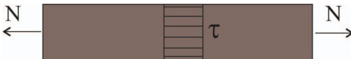
Figura 6 – Distribuição de tensão em barra tracionada.
