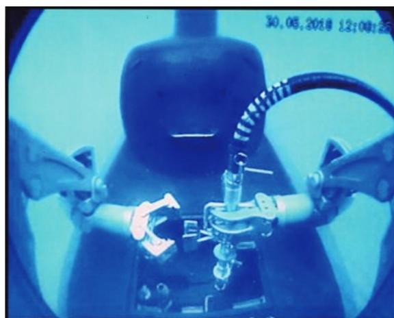
Figura 4: Conexão realizada pelo *Remotely Operated Vehicle* – ROV.
