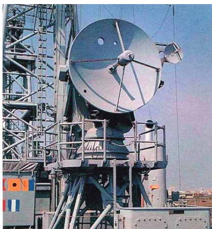
Figura 3 – Antena-radar revestida com RAM.
