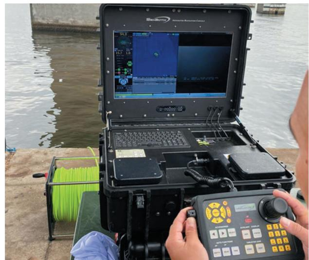
Figura 10: Console do ROV.
