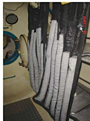
Dispositivo de Absorção Passiva de Dióxido de Carbono - DAPDC
