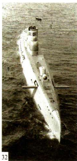
Submarino alemão tipo "XXI", desenvolvido e construído durante a II Guerra Mundial. Podia navegar 170 milhas a 8 nós em imersão.
