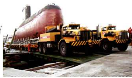
Submarino Timbira sendo tracionado para o interior da Oficina de Sb. do AMRJ.
