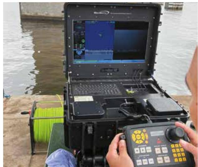
Figura 10: Console do ROV.
