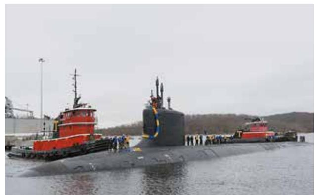
Figura 3: Submarino da Classe Virginia com telhas faltando.
