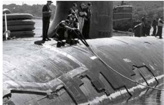
Figura 2: Revestimento do submarino se desprendendo.
