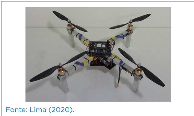
Figura 3. Quadricóptero utilizado para a definição do modelo matemático.
