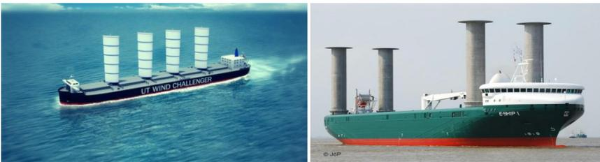
À esquerda uma imagem ilustrativa do uso de velas; à direita uma imagem real de um navio de apoio *offshore*<sup>34</sup> com rotores Flettner em ambas as extremidades da embarcação
