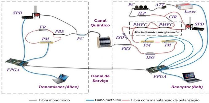
Figura 8: Rede criada pela China quebrando recorde de distância de QSDC (adaptado de ZHANG, H. et al., 2022).
