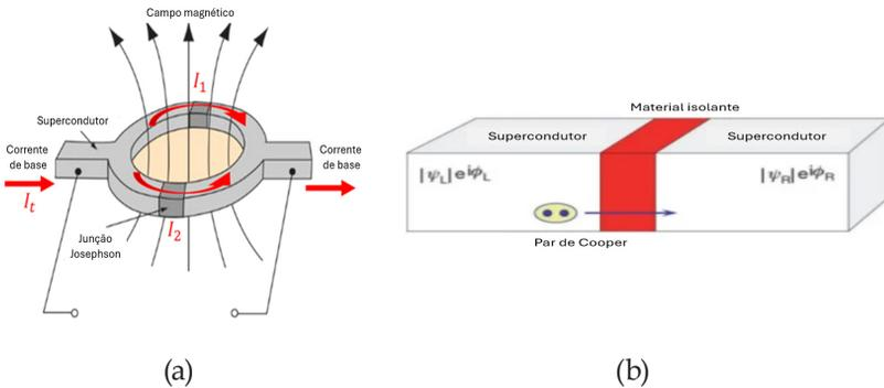
Figura 2: (a) Esquema de sensor SQUID; (b) esquema de junção Josephson.
