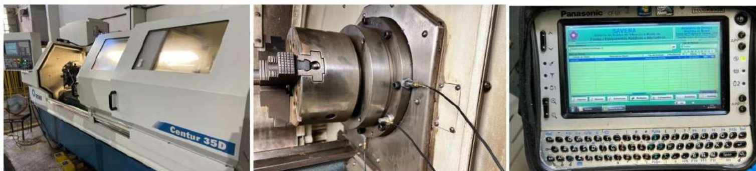
Figura 5 - Montagem dos sensores no Torno CNC
