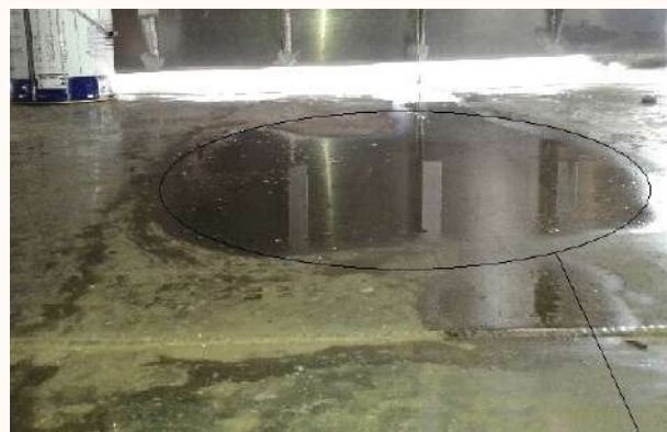
Figura 2 – Convés Principal do Navio-Patrolha de 500 Toneladas, Empeno Abaixo do Compartimento do Passadiço
