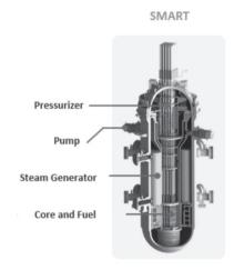
Figura 7 - Reator modular coreano Smart
