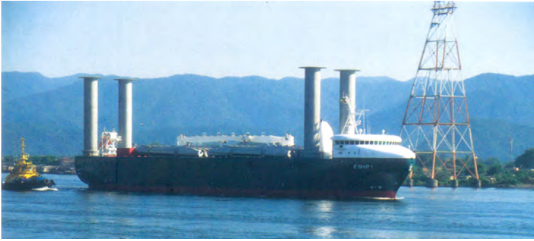
E-Ship 1 , com quatro rotores de 27 metros de altura
