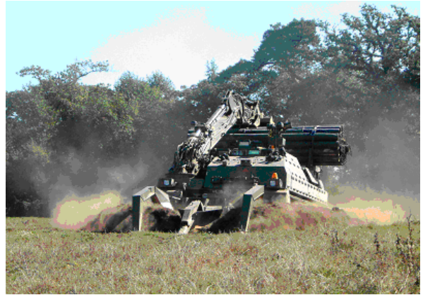
Trojan – Equipamento Blindado de Engenharia para Abertura de Brechas em Campos Minados
