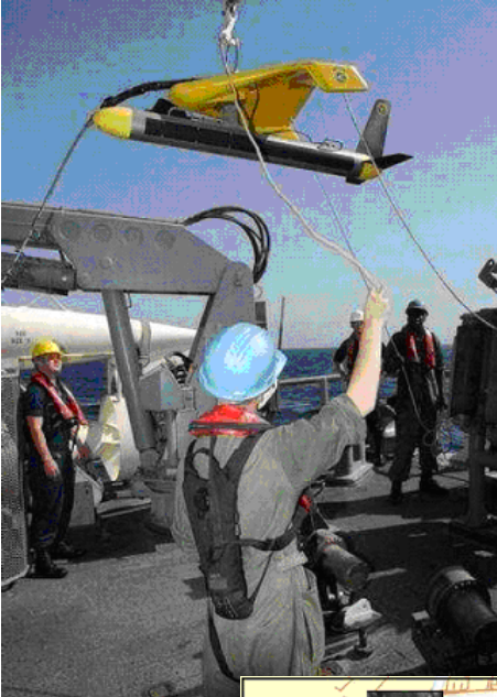
Foto 3 – Lançamento de um side scan
