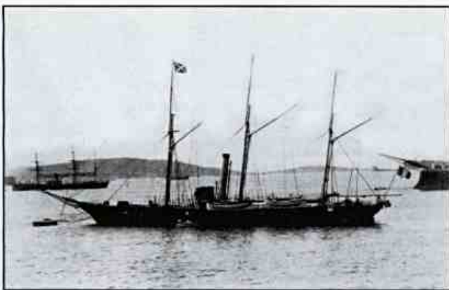
Aviso Corse , primeiro navio de guerra a utilizar hélice em sua propulsão. Lançado em 1842 como navio de passageiros, em 1850 foi incorporado à Marinha francesa, onde serviu por quase 50 anos. Superou 12 nós e, aos 29 anos de serviço, navegou 11.000 milhas sem avaria. (Foto: Proceedings)
