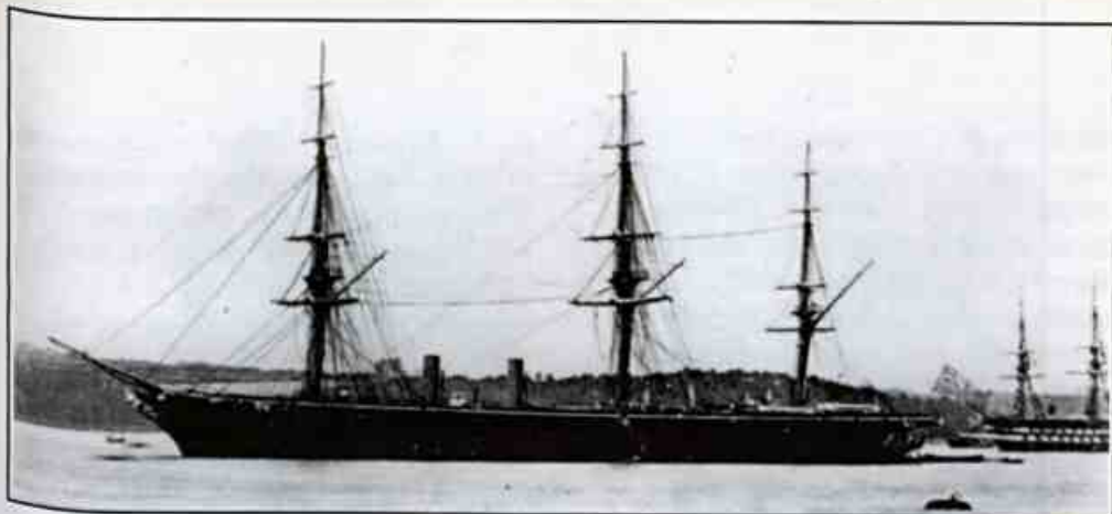
O inglês Warrior (1860). Primeiro navio de linha com casco de ferro (Foto USNIP)
