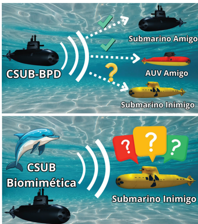
Figura 1 – (a) Acima, a esteganografia com baixa probabilidade de detecção. Os sinais são visíveis apenas aos sonares e receptores amigos, reduzindo a probabilidade de detecção por submarinos inimigos. (b) Abaixo, a esteganografia biomimética camufla as mensagens em sons biológicos conhecidos, como golfinhos e baleias, confundindo os sonares inimigos. Sem saber se a transmissão é real ou sintética, a partir de um submarino, o contato é descartado e tratado como ruído.
