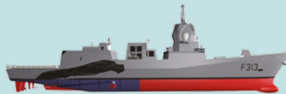
Figura 13 – Alagamento dos compartimentos da fragata
